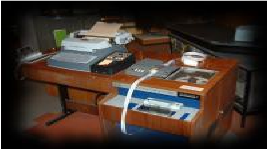
PREPAMAT adat előkészítő berendezés, fejlesztette a VILATI
