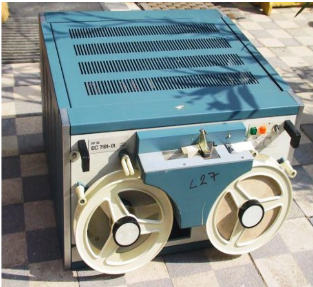
AZ ELEKTROMECHANIKAI ÉS FINOMMECHANIKAI Vállalat és a MOM fejlesztette, gyártotta lyukszalag olvasó (a lyukasztóról nem maradt fenn kép)
