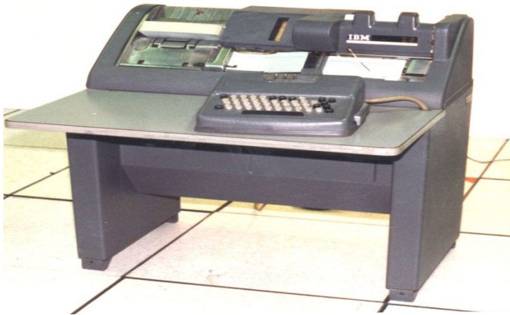
IBM programdob vezérelt, másolóágyas, lyukasztó / ellenőrző gép
